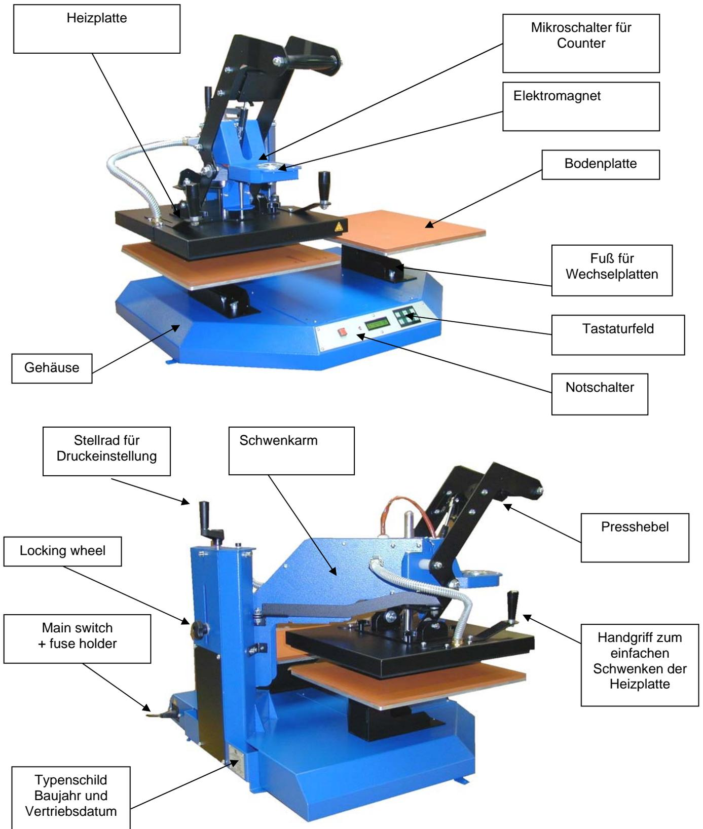
Die Thermopresse ist für Anwender konzipiert, die unmittelbar vor der Maschine arbeiten.
